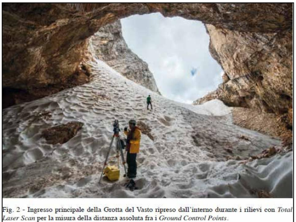
Fig. 2 - Ingresso principale della Grotta del Vasto ripreso dall'interno durante i rilievi con Total Laser Scan per la misura della distanza assoluta fra i Ground Control Points.
