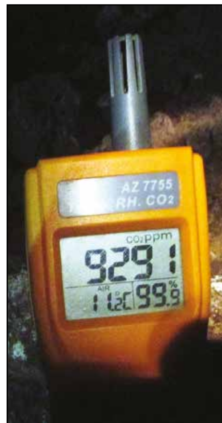
Fig. 4: misure dell'anidride carbonica in una grotta del Carso a circa 21 metri di profondità dalla superficie: 9291 ppm. All'esterno era 410 ppm. Come si può notare, elevate concentrazioni di CO_2 si possono avere anche a profondità relativamente modeste.
