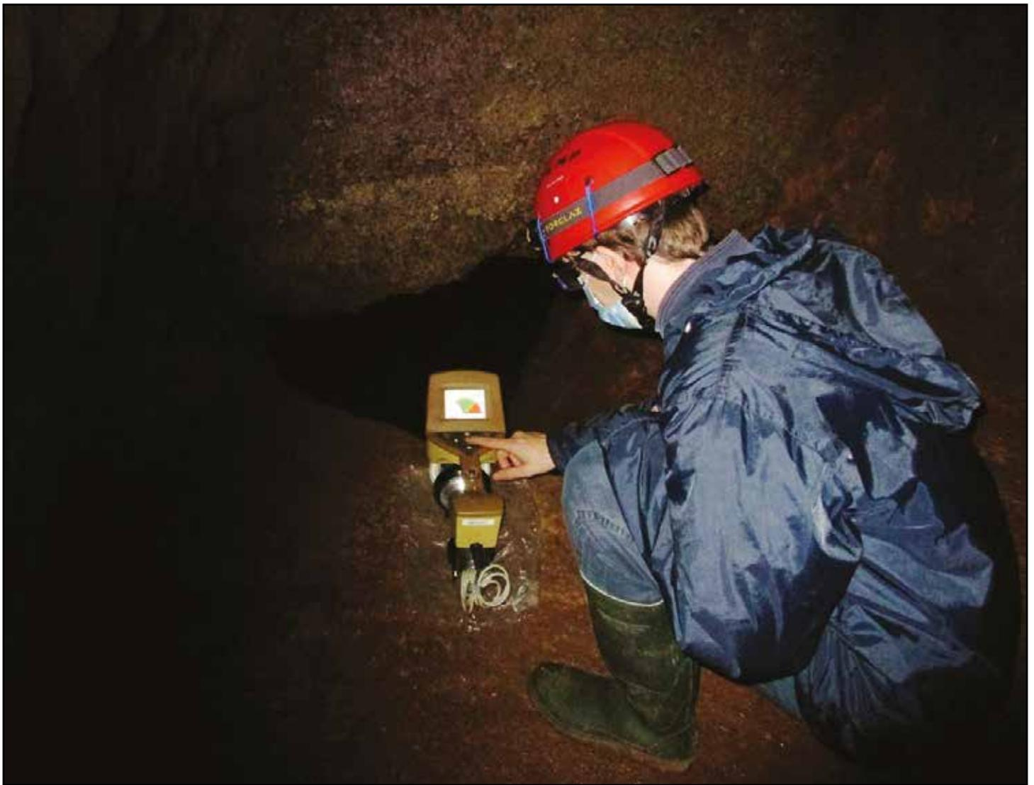
Fig. 2: durante una ricerca, effettuata nell'ottobre 2020 nella caverna Generale Ricordi presso Jamiano, lo schermo dello spettrometro gamma indicava la presenza di tre radionuclidi: potassio40 (K40), bismuto214 (Bi214) e radio226 (Ra226). La radioattività era pari a 0,20  $\mu\text{Sv/h}$ , cioè circa il doppio di quella esterna.
