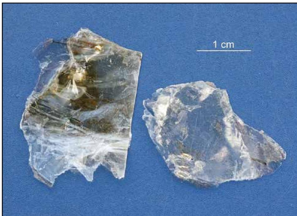
Fig. 1: lamelle di muscovite, dallo spessore inferiore al millimetro. Questo minerale appartiene al gruppo delle miche con formula:  $K_2Al_3(Si_6Al_2O_{20})(OH)_4$ . L'illite, presente in molte argille di grotta, ha una notevole somiglianza con la muscovite, ma rispetto a questa ha un minore contenuto in potassio, inoltre i cristalli sono minutissimi perciò viene identificata soprattutto con la diffrattometria a raggi X.
