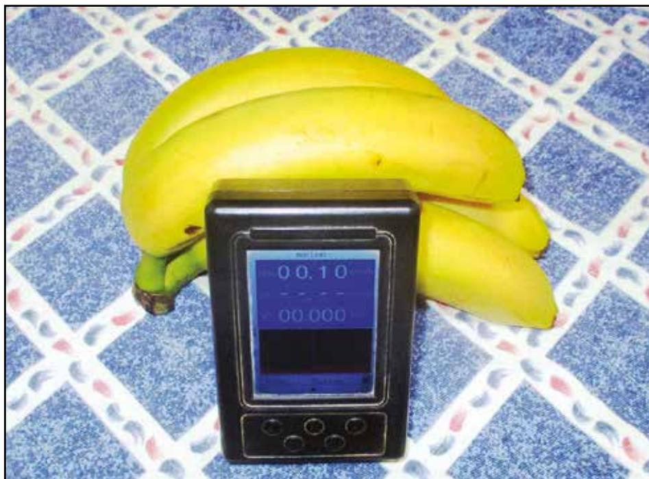
Fig. 3: tentativo di misura della radioattività delle banane. Il valore non si discosta da quello della radioattività di fondo.
